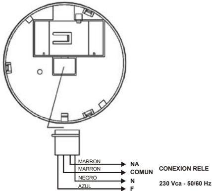
Conectar el conector en la parte trasera del detector como se muestra en la figura anterior. Este conector solo se puede conectar en una posición. Asegúrese de que queda fijado correctamente.
