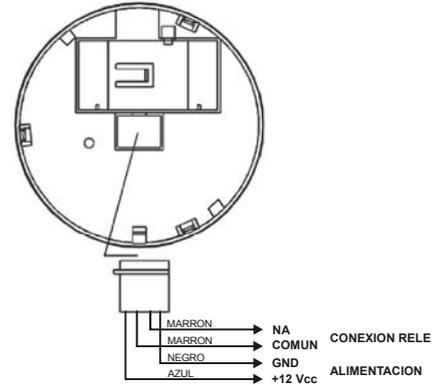
Conectar el conector en la parte trasera del detector como se muestra en la figura anterior. Este conector solo se puede conectar en una posición. Asegúrese de que queda fijado correctamente.
